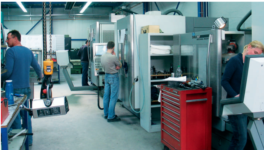
Wachstum: Die breite Angebotspalette trug dazu bei, dass Ebel & Rickert die Zahl der Mitarbeiter von 2002 bis 2007 verdreifachen und das Betriebsgebäude um eine weitere Halle erweitern konnte. Bearbeitungszentren (DMG) sowie Drahterodiermaschinen (Makino) arbeiten am Wochenende und nachts im Mannlosbetrieb.
