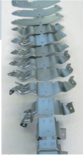
Prüfung: Nach Fertigstellung des Werkzeugs werden die ersten Probestreifen gefertigt.
